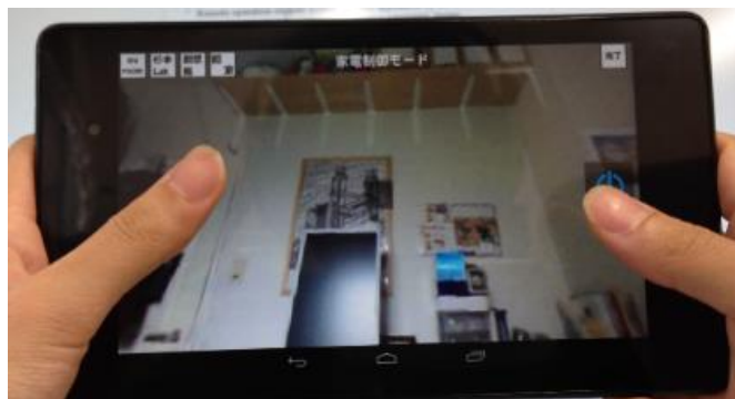
図1 提案システム：パノラマ画像を観覧し、画像中の家電に対しON/OFFの制御が可能
